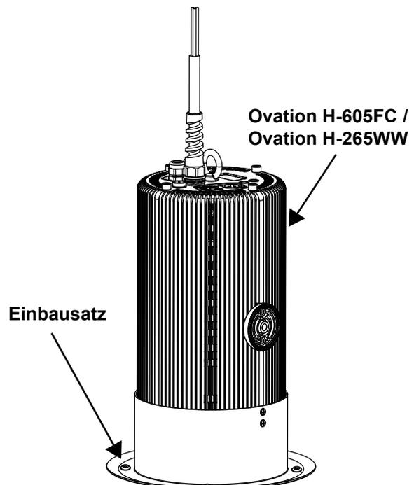
4. Befestigen Sie die Leuchte mit 4 Stück M4-Schrauben an der Decke.
