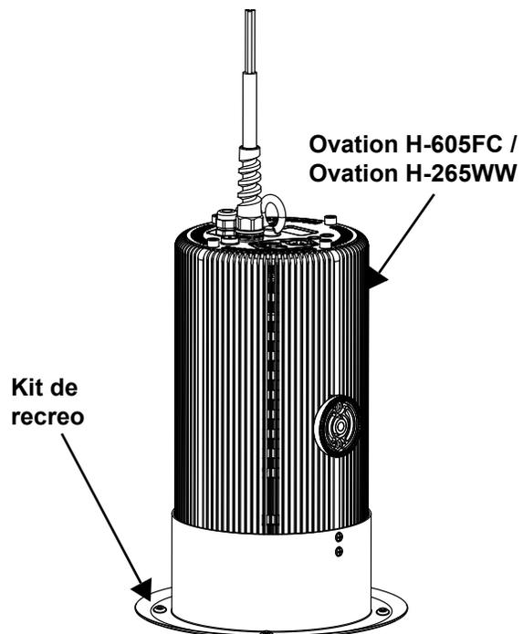
4. Fije el dispositivo al techo con 4 piezas de tornillos M4.
