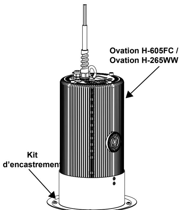
4. Fixez le luminaire au plafond à l'aide de 4 vis M4.
